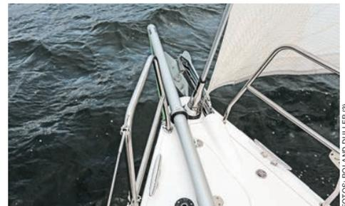
**SINNVOLL.** Der Bugspriet kann in den Rumpf integriert werden oder außen liegen (oben)
