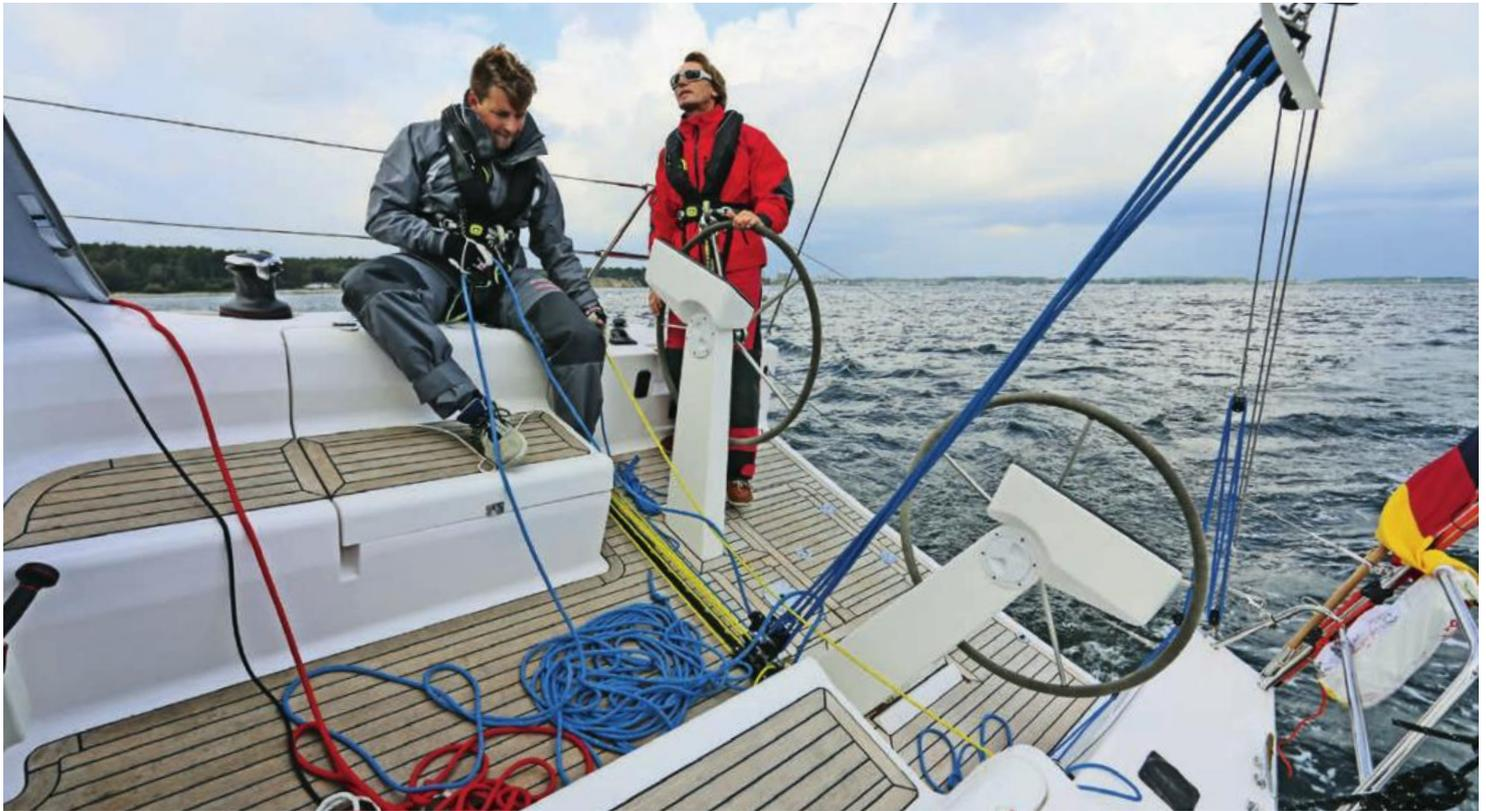
**ARBEITSTEILUNG.** Der Großtrimmer kann Schot und Traveller gut bedienen, der Steuermann sieht die Fäden in der Genua und steht dank Teakleiste auch bei Lage sicher
